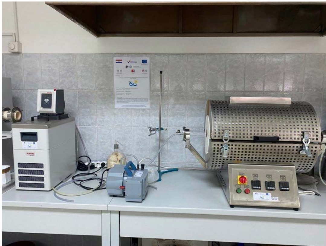
Custom-made višezonska cijevna peć za vakuumsku pirolizu ili pirolizu u struji inertnog plina, izrađena kroz projekt OS-Mi.
